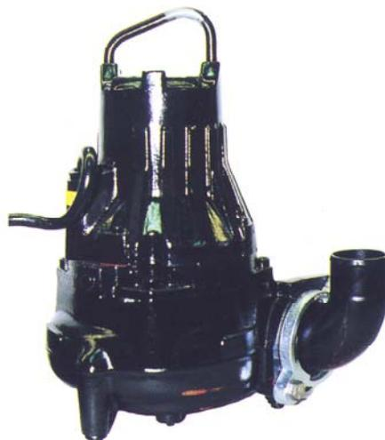
Alternativ dazu wird in der Mörtelverarbeitung die HS 3085 eingesetzt. Die HS 3085 hat eine gekapselte Gleitringdichtung, ein gehärtetes Laufrad und Verschleißeinlagen. Der freie Durchgang beträgt 70 mm und das Fördermedium wird direkt aus dem Pumpengehäuse in den Druckabgang geleitet.
