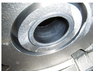
Carbon lagerbussen, ingesleten.
