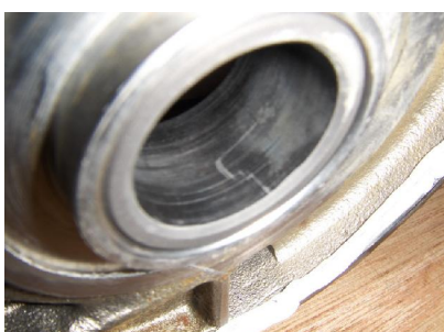
Carbon lagerbussen, ingesleten.
