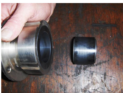
Silicium lagers en bussen, ingesleten.
