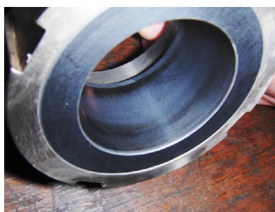
Silicium lagers en bussen, ingesleten.
