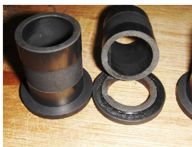
Gebroken carbon taats lagerbus gelijmd.
