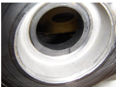
Stuk uit carbon lagerbussen gebroken.
