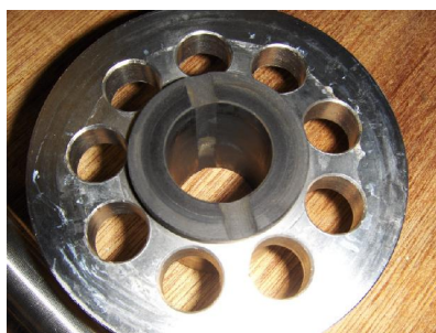
Carbon taats lagerbussen, ingesleten.
