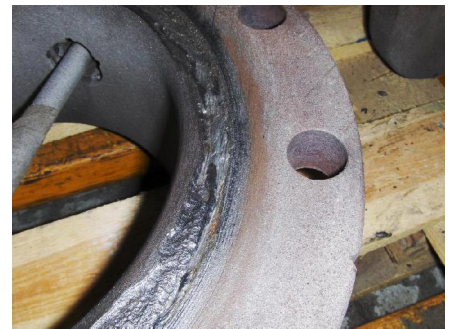
Zuigstuk, afdichtingsvlak aangetast
