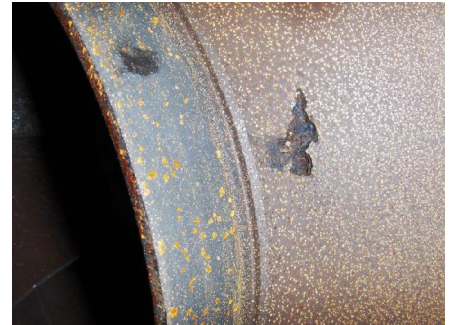
Waaier aangestast door cavitatie
