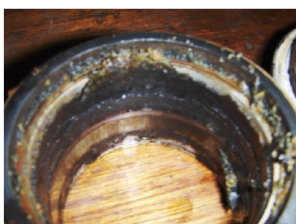
Mech. seal ingesleten en vervuild
