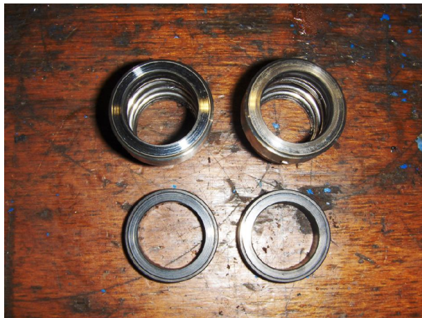
Mech. seals met beide inloopschade
