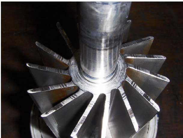
Brede schoepenwiel met aanloepschade
