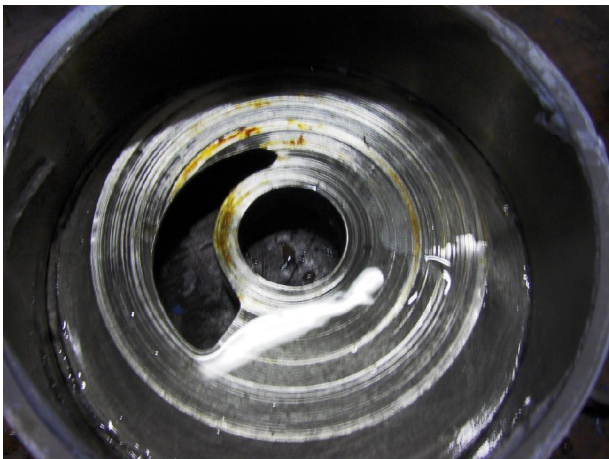
Stuurschijf perszijde met inloopschade
