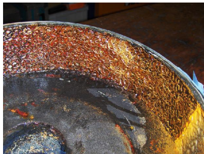
Huizen, waaier en tussenstukken, ernstig aangetast door, inslijting, uitwassing, put corrosie etc
