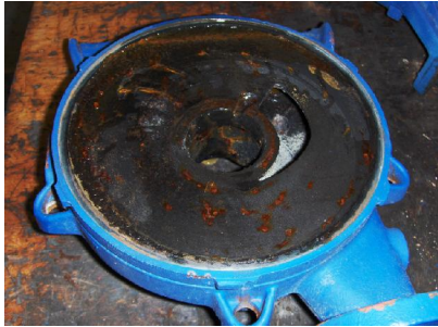
Huizen, waaier en tussenstukken, ernstig aangetast door, inslijting, uitwassing, put corrosie etc.
