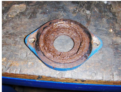
Lagerhuizen, deksels en lagers, ernstig vervuild.
