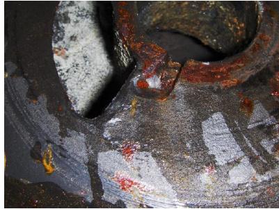
Huizen, waaier en tussenstukken, ernstig aangetast door, inslijting, uitwassing, put corrosie etc.
