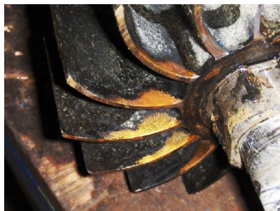
Huizen, waaier en tussenstukken, ernstig aangetast door, inslijting, uitwassing, put corrosie etc
