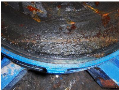
Huizen, waaier en tussenstukken, ernstig aangetast door, inslijting, uitwassing, put corrosie etc
