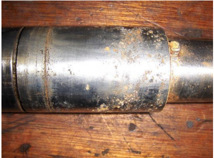
Pompas, ernstig aangetast door putcorrosie.
