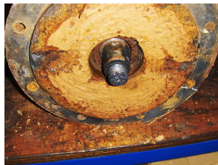
Pakkingkamer vervuild door aanslag
