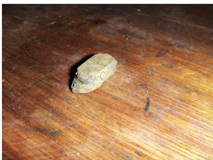
Waaier spie, ernstig aangetast door corrosie.
