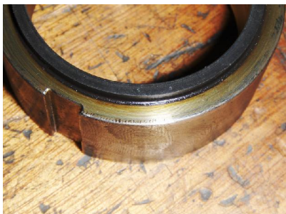
Glijvlak Mech. Seal, ingesleten.
