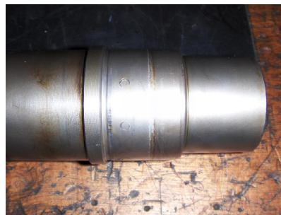
Asbus, t.h.v. het Mechancial Seal aangetast door putcorrosie.
