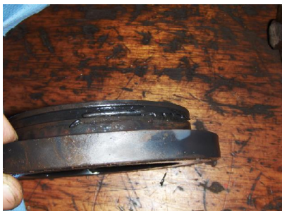
O-ring af gebrokkeld door uitharding.
