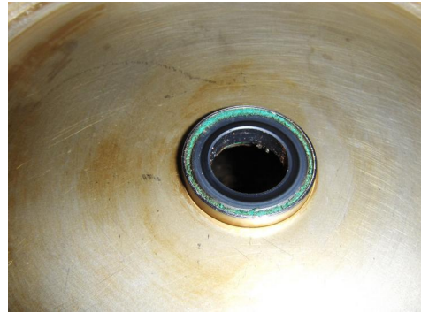
Glijvlak Mechanical Seal ingesleten..
