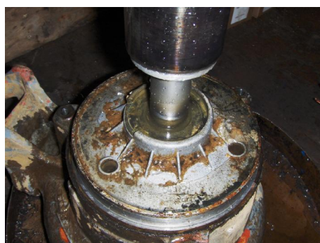
Medium en olie resten in E-motor
