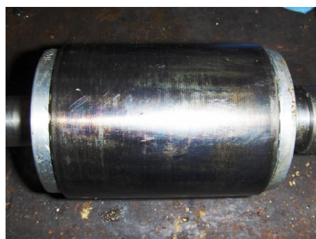
Rotor van E-motor, blauw verkleurd door verbranding.
