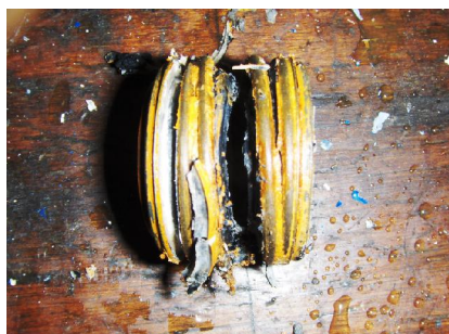
Mechanical Seal, ernstig beschadigd.
